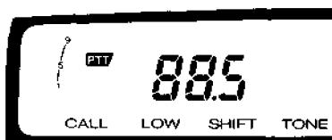
3 Поворачивайте ручку управления **Настройки**, или нажимайте кнопку микрофона [UP]/[DWN] и выбирайте частоту Тона.
