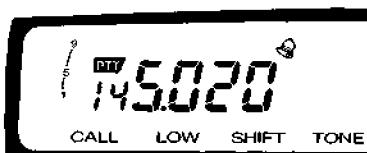
4 Когда правильный сигнал получен, приемопередатчик звонит 3 раза, "bell" начинает мигать, и срабатывает Call Number.
